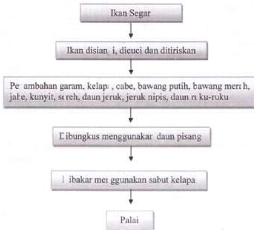
Gambar 1. Diagram Alir Proses Pembuatan Palai Bada Secara Tradisional
